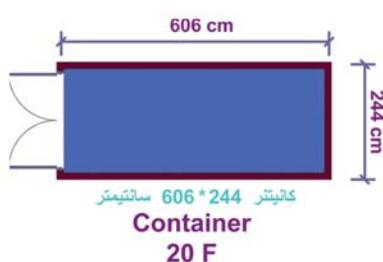
انواع کانتینر ۲۰ یا ۴۰ فوت بصورت تک چداره یا چند چداره اجرا شده جهت انبارها ، کارگاه های ساختمانی ، نصب دستگاه ، حمل بار، صنایع دریابی ، حمل بار دریابی (کشتی های کانتینر بر) ، حمل حامل های انرژی ژنراتور و دیزل های صنعتی ، کاربری در صنایع نظامی و دفاعی.
